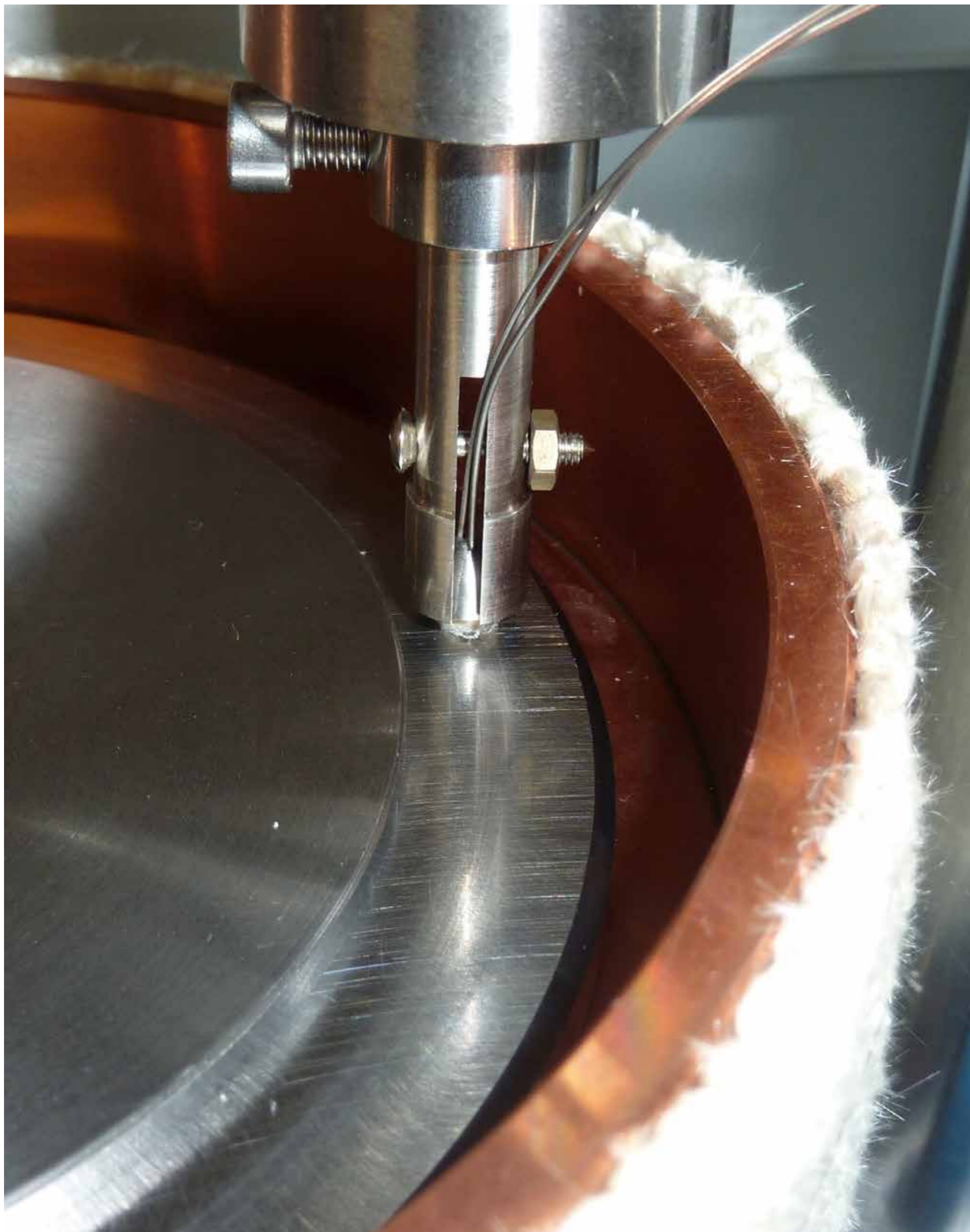
Abbildung 1: Beheizbares Stift-Scheibe-Tribometer zur Untersuchung der Temperaturabhängigkeit von Reibung und Verschleiß von Polymeren (Polymerprobe im Stift, versehen mit Temperatursensoren, Reibpartner Stahl). (© Fraunhofer IWM)
