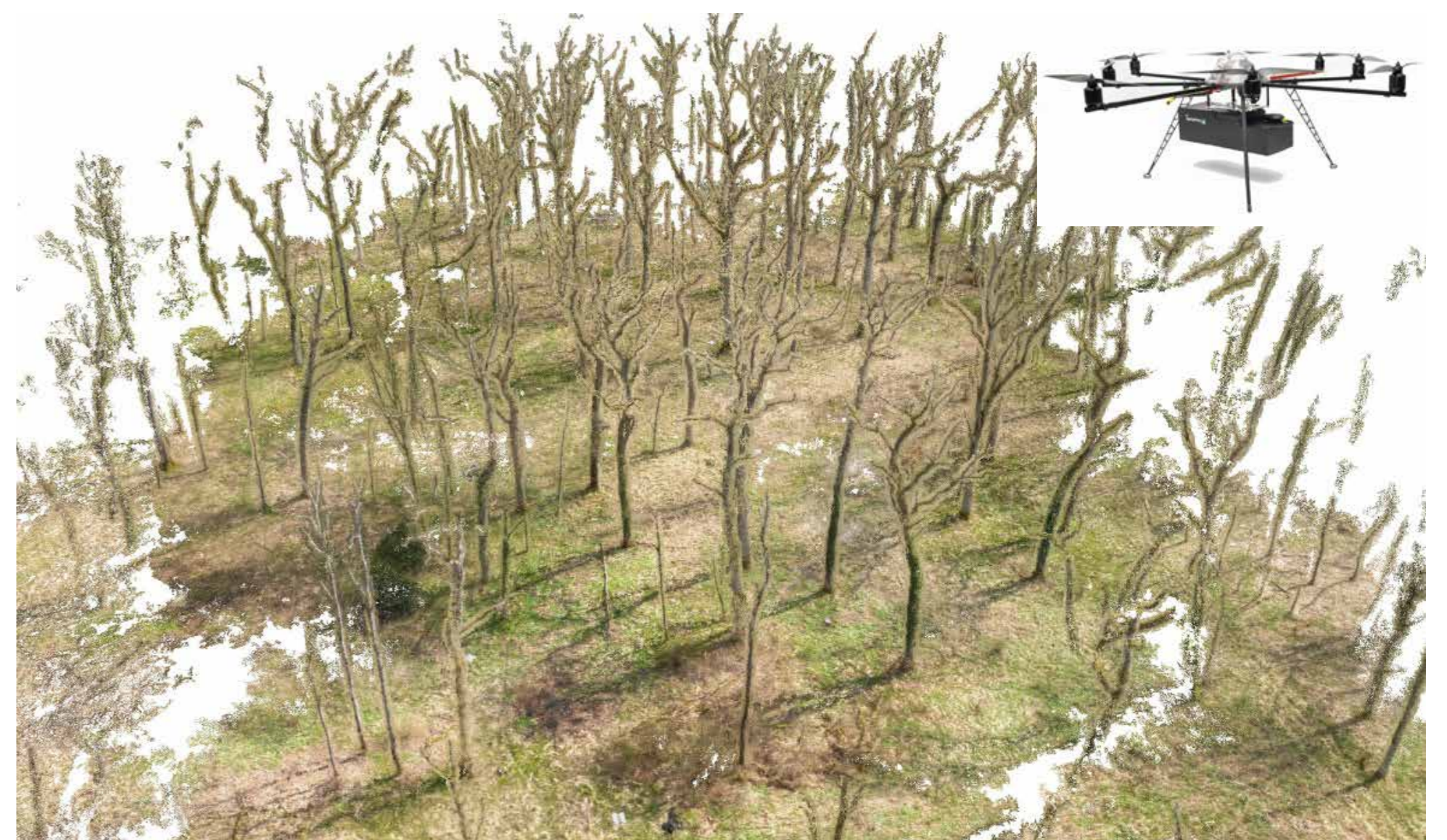
Abbildung 2: Ein gewichtsoptimierter Laserscanner kann 3D-Gelände- und Vegetationsdaten sehr effizient aus der Luft erfassen. (© Fraunhofer IPM/Uni Freiburg)
